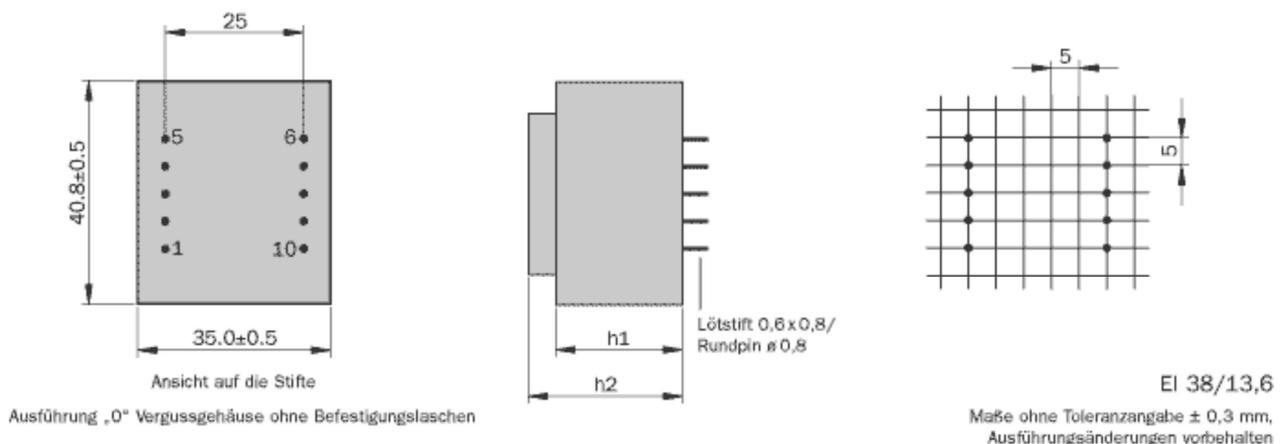
Maße in der Zeichnung ohne Toleranzangabe  $\pm 0,3$  mm. Lötstifte 0,6 x 0,8 mm. Abbildung mit Standardraster und Standard - Stiftbelegung.
