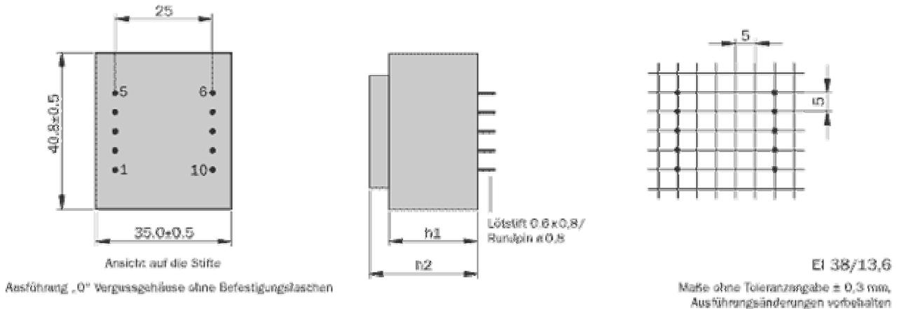
Maße in der Zeichnung ohne Toleranzangabe +/- 0,3 mm. Lötstifte 0,6 x 0,8 mm. Abbildung mit Standardraster und Standard - Stiftbelegung.
